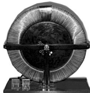
Teslin indukcijski elektromotor - 90% svih elektromotora u svijetu za rad koristi okretno magnetsko polje prvi put korišteno kod ovog motora.
