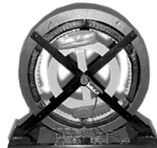
Teslin trofazni generator - danas taj tip nalazimo u svim elektranama u svijetu (inače, elektrane su postrojenja u kojima se proizvodi električna energija - to je ono što trese u utičnicama).
