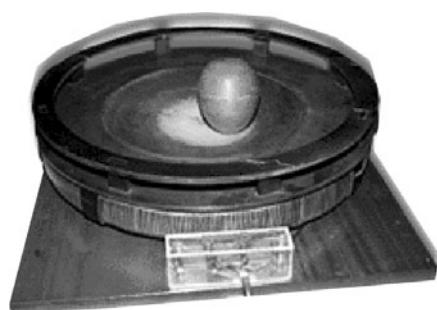
Teslino rotirajuće jaje-naprava za demonstriranje djelovanja okretnog magnetskog polja.
